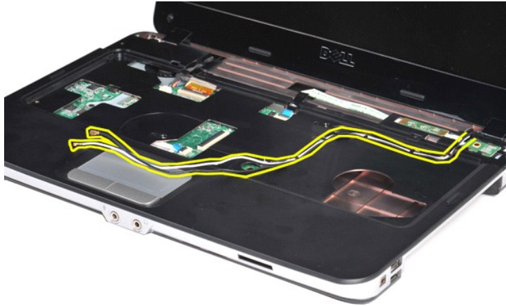
12. หมุนกลับยึดสายอินเวอร์เตอร์ของจอแสดงผลเพื่อถอดสายอินเวอร์เตอร์ของจอแสดงผล
