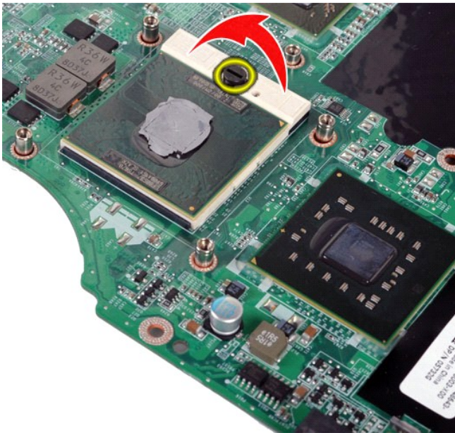
20. ถอดไขควงตัวประมวลผลออกจากบอร์ดระบบ
