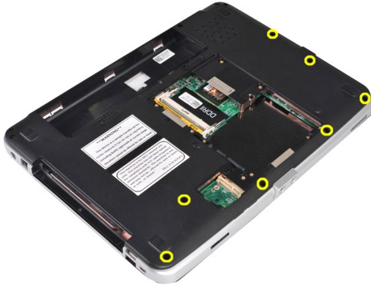
11. ถอดสกรูที่ยึดที่วางฝ่ามือกับคอมพิวเตอร์ในช่องใส่สื่อ
